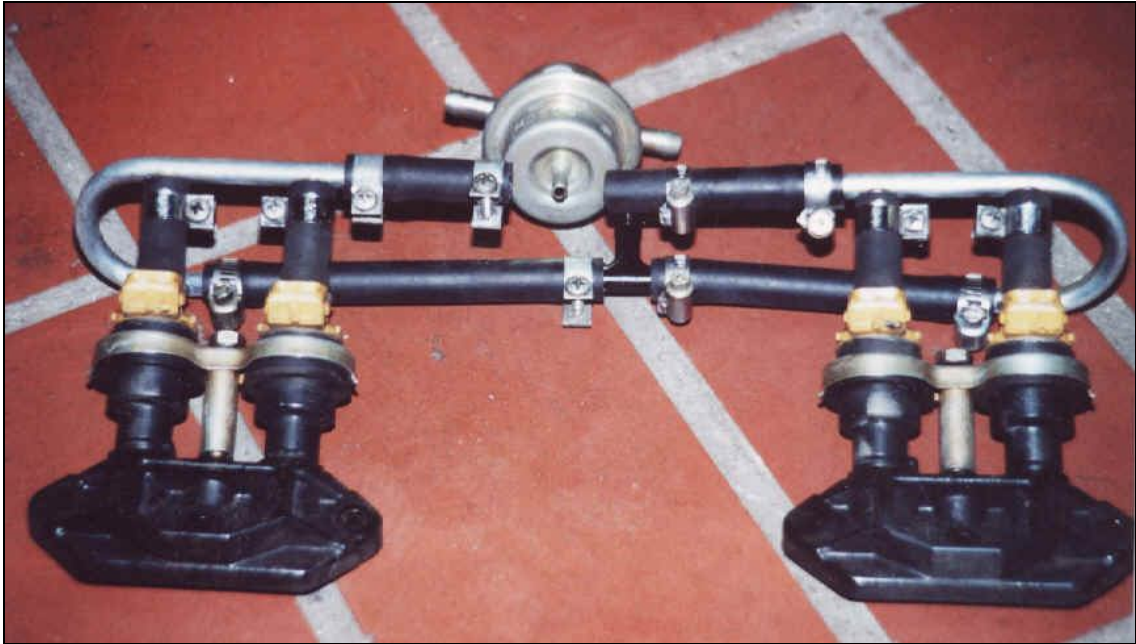
Bild 4.6.1-7 Foto Versorgungsleitung inkl. Einspritzdüsen
