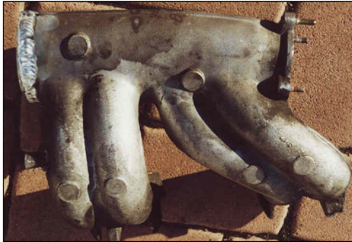
Bild 5.2.1.8-1 Foto Umgearbeitetes 6 – Zylinder - Saugrohr
