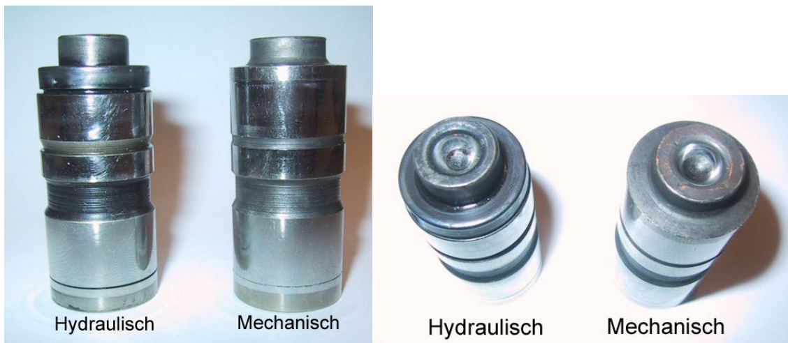
Bild 4.7-4 Fotos: Vergleich hydraulischer / mechanischer Stößel
