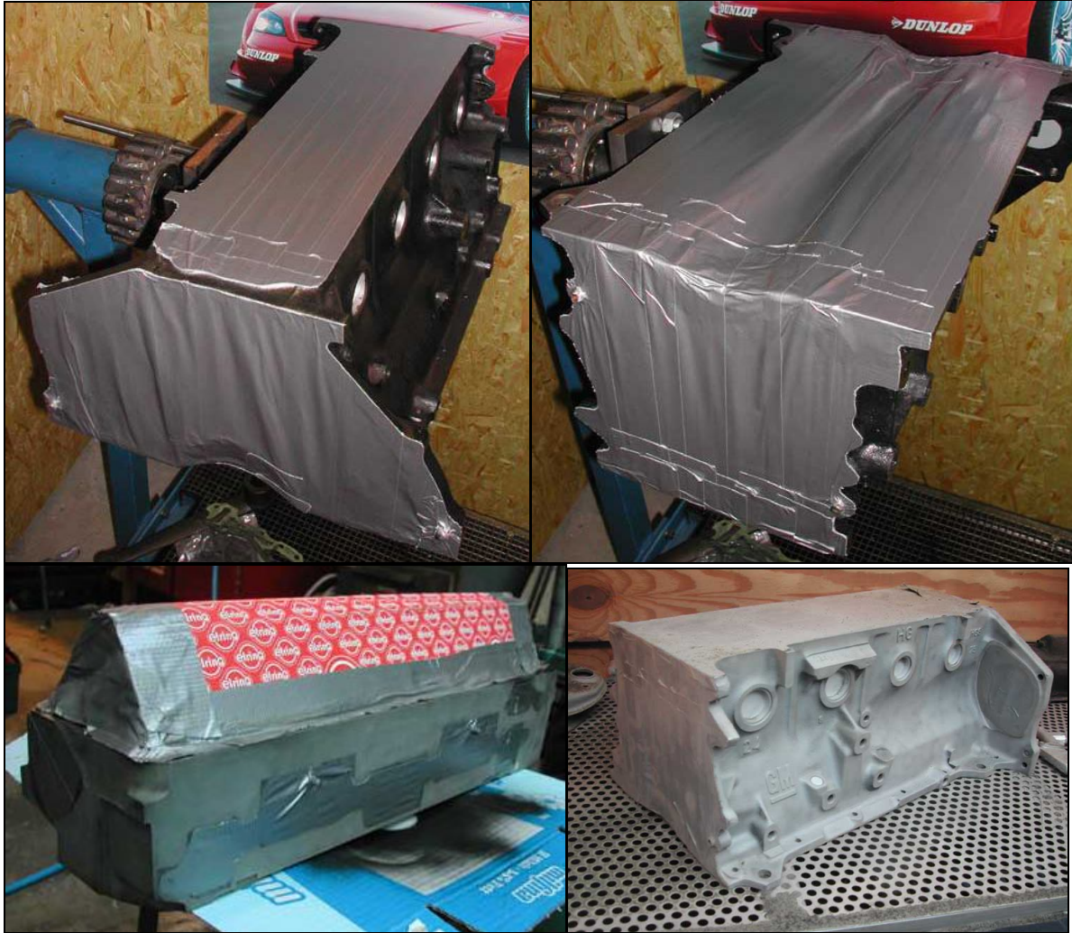
8.3-4 Fotos abgeklebter und sandgestrahlter Motor
